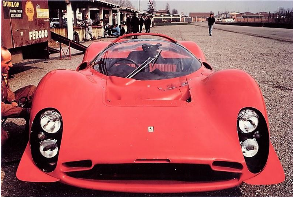
Modena Aerodromo, fine autunno 1966. Collaudo della 0846, la prima 330 P4 ricavata da una P3 dell'anno precedente. Il cofano anteriore ha ancora la piccola presa d'aria centrale caratteristica della P3.
