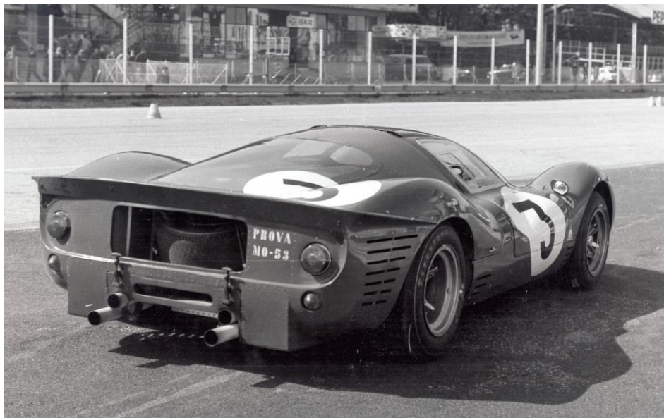
La P4 0856 di Bandini-Amon alla 1000 Km di Monza 1967. Evidenti le linee armoniose, eleganti, aerodinamicamente discutibili (ma allora non si conosceva nulla di più scientifico ed efficace). Visibili i due volumi per le valigie virtuali, imposte dal regolamento.
