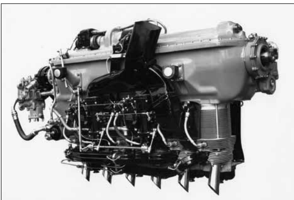
Motore tipo 115 ter 1950, estrema evoluzione del dopoguerra del tipo 115-l del 1936, versione costruita in Alfa Romeo dell'inglese De Havilland Gipsy six. Motore a 6 cilindri in linea invertiti raffreddati ad aria da 195 CV, evoluto nel 1939 nella versione 115 Bis e successivamente nella Ter, qui raffigurata, in grado di erogare 220 CV al decollo. Veniva prodotta anche la versione a 4 cilindri, denominata 110. Le varie versioni vennero prodotte in migliaia di esemplari fino al 1952.
