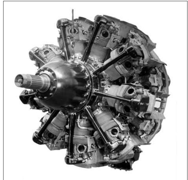
Motore tipo 135 R.C. 32, 18 cilindri in doppia stella, 48.200 cc, 1.700 CV previsti al decollo, impostato nel 1935. I primi esemplari furono costruiti nel 1937, e, come i coevi 18 cilindri radiali italiani Piaggio e gli americani Curtiss-Wright e Pratt & Whitney, ebbe una lunga e laboriosa gestazione. Ne furono costruiti 150 esemplari per i tedeschi e diedero origine a due versioni evolute rimaste allo stadio di prototipo, il 136 R.C. e il 138 R.C., quest'ultimo dotato di compressore di sovralimentazione a 2 velocità per permettere di erogare alte potenze a bassa quota, utili durante la fase di decollo, e ad alta quota.
