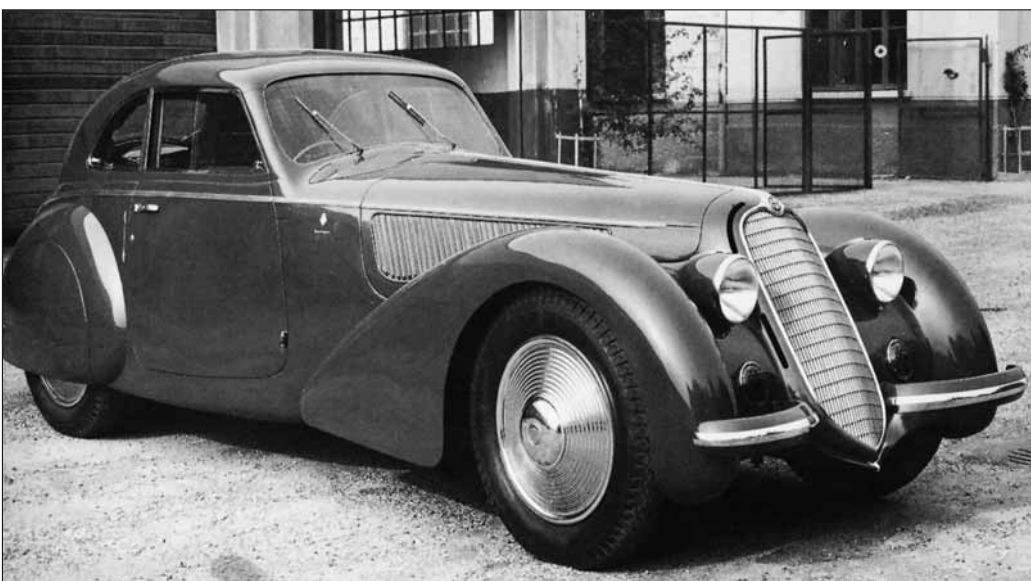
Le 8C, prima di 2.300 cc con telaio a balestre, poi dal 1936 di 2.900 cc con sospensioni indipendenti, sono considerate il nec plus ultra dell'automobile sportiva anteguerra. Però il loro costo ne ha limitato la produzione a poco più di 200 esemplari in 10 anni. Hanno lasciato il segno fino ad oggi per prestazioni, eleganza e prestigio, non certo per la rilevanza industriale.
