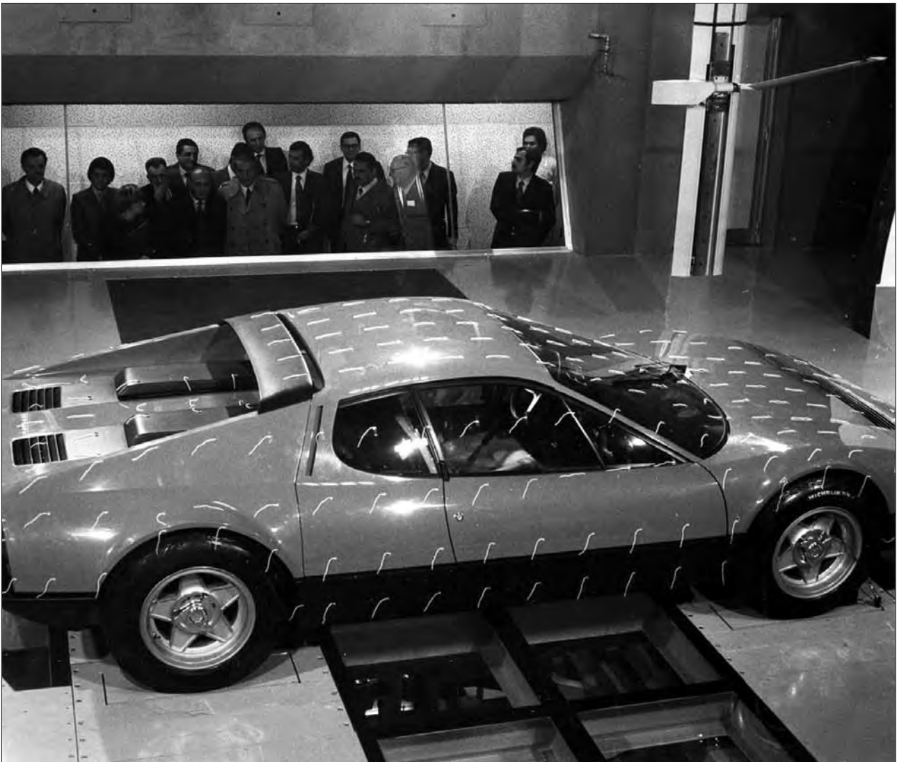
La Ferrari 512 BB nella galleria del vento Pininfarina durante una visita della stampa nel 1976. I fili di lana erano il metodo standard per valutare la finezza aerodinamica delle carrozzerie. Allora, nessuno, in Italia, pensava alla deportanza quale risultato fondamentale dello studio aerodinamico.
