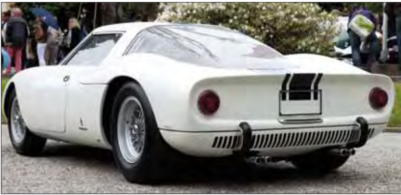
Ferrari 250 LM Berlinetta Speciale 1965, commissionata da un ricco cliente americano e presentata al Salone di Ginevra 1955. Rispetto alla carrozzeria da competizione, caratterizzata dalla troncatura posteriore dell'abitacolo, la linea è continua, il cofano anteriore è più deportante e le due aperture sopra i parafranghi posteriori sono state integrate nella forma. La vettura è stata ripresentata al Concorso di Villa d'Este 2013.
