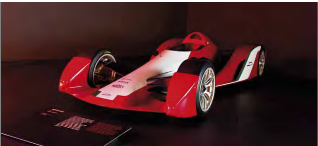
Fioravanti LF1, proposta di monoposto F1 a effetto suolo, con sicurezze insite nella carrozzeria, quali le carenature anteriore e posteriore per evitare gli agganci: soluzione già presente nella Sigma Grand Prix del 1979.
