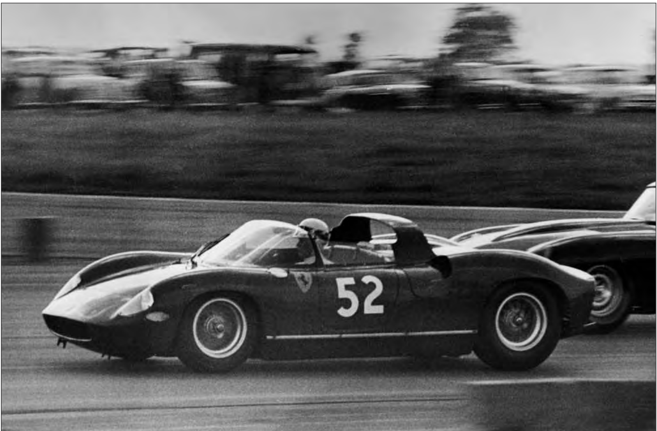
Il "nuovo mondo" Ferrari delle Sport Prototipo a motore centrale iniziò nel 1963 con la 250 P, un modello che sconvolse un po' tutti a Maranello. Il roll-bar, che perfezionava quello già visto sulla TRI-62, aveva una funzione aerodinamica di grande importanza in quanto indirizzava il flusso d'aria verso il basso della coda, aumentando l'efficacia dello spoiler. La foto è stata scattata a Silverstone. Al volante, Mike Parkes.
