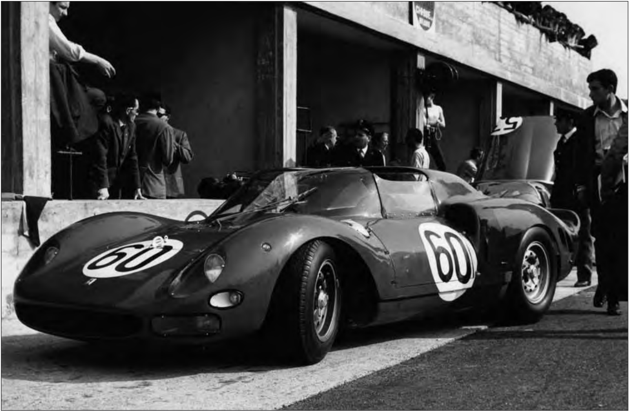
Ferrari 330 P2, telaio 0828, di John Surtees-Ludovico Scarfiotti, secondi classificati nella 1000 Km di Monza 1965. Le linee "pulite" dei precedenti modelli della Serie P qui sono state esasperate nel roll-bar sagomato, molto più largo, nella coda decisamente bassa e nel grande spoiler a tutta larghezza.
