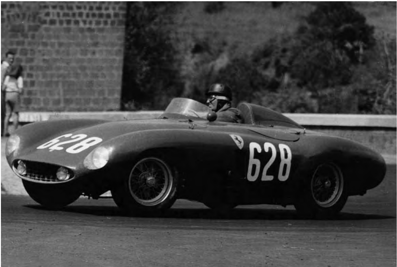
La Mondial 0536 MD di Luigi Taramazzo alla Mille Miglia del 1 maggio 1955. Si ritirerà dopo Bologna. Sia le 500 Mondial che le 750 Monza assumono nel 1955 un andamento fortemente bombato con i parafanghi che ricadono sui passaruota.
