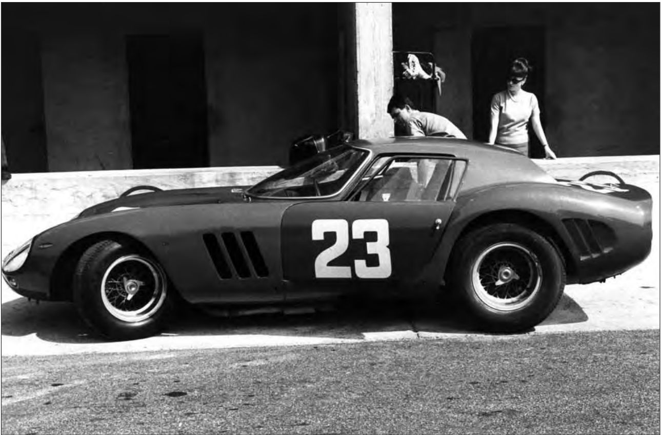
Ferrari GTO/LM 64, telaio 4675, di Luigi Taramazzo-Giorgio Pianta alla 1000 Km di Monza 1966. La carrozzeria è chiaramente ispirata alla 250 LM di Pininfarina: il tettuccio tagliato ha solamente una valenza estetica e non quella di indirizzare il flusso d'aria sullo spoiler appena pronunciato al bordo superiore della coda Kamm.
