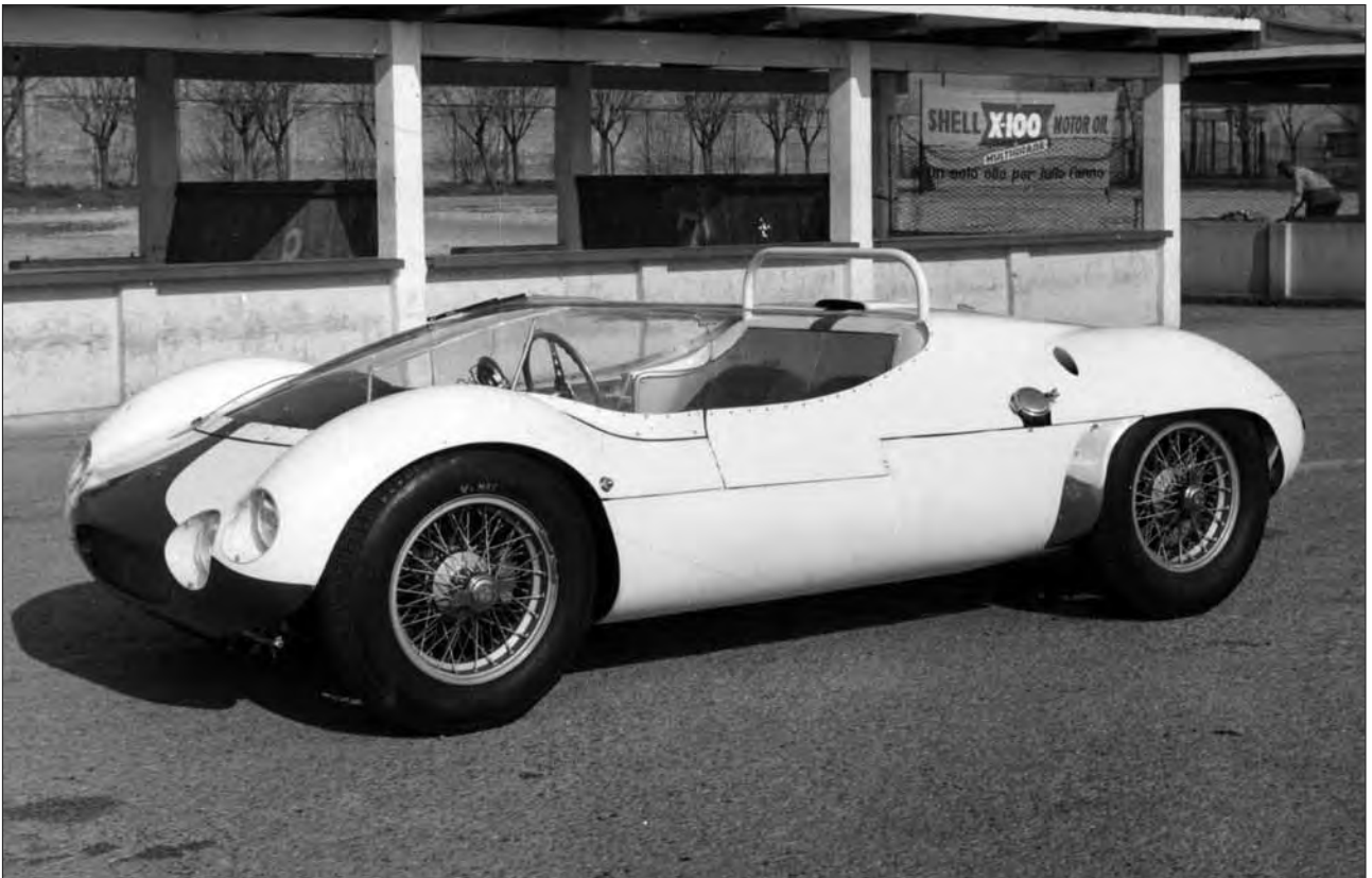
Maserati Birdcage a motore centrale e parabrezza regolamentare per Le Mans, carrozzata da Allegretti e Gentilini, che hanno costruito anche le carrozzerie delle Maserati Tec-Mec, Tipo 60 e 61, Tipo 151.
