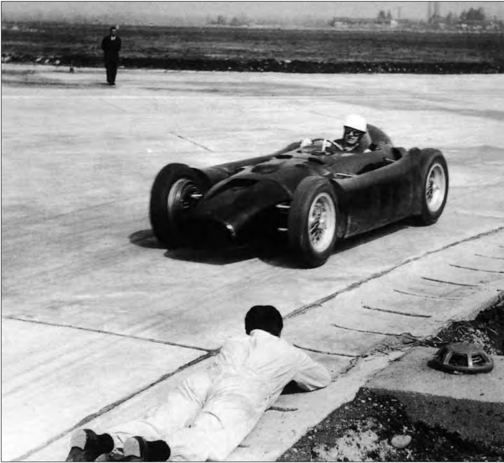
Collaudo all'Aeroporto di Caselle (Torino). Non esistendo la telemetria, Alberto Ascari si è sdraiato nella scolina per vedere di persona il funzionamento delle sospensioni anteriori mentre Gigi Villoresi sta guidando per la prima volta la D50.
