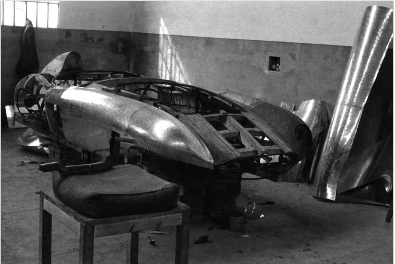
La fase precedente il montaggio sulla vettura era il controllo delle varie parti della carrozzeria sul manichino in legno. Il manichino veniva realizzato quando era prevista la produzione di più esemplari.
