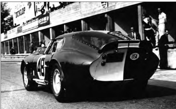
La vista posteriore della Cobra Daytona Coupé, qui alla 1000 Km di Monza 1965, permette di notare la coda Kamm e lo spoiler centrale
