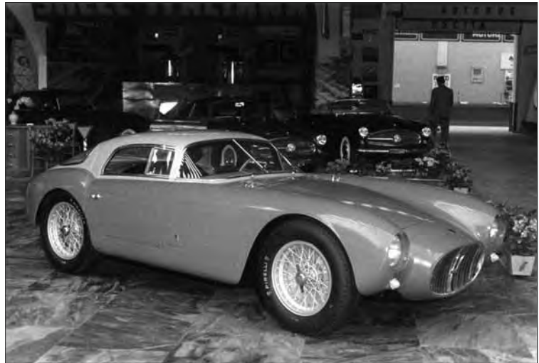
Un'immagine della Maserati A6GCS berlinetta scattata al Salone di Torino del 1954 ci mostra l'insolita livrea bicolore in due toni di azzurro, evidenziandone le peculiarità rispetto alle altre tre vetture sorelle: la minore altezza, il parabrezza diviso e la coda tondeggiante e priva delle pinnette posteriori.
