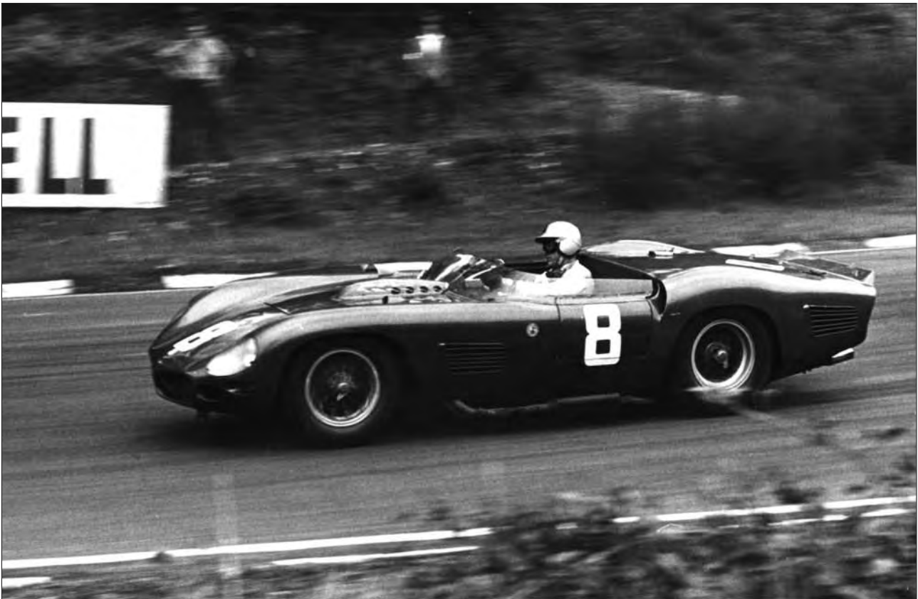
Ferrari TRI, l'ultima Sport a motore anteriore costruita a Maranello e utilizzata in corsa dal 1960 al 1962. Qui è a Brands Hatch. La carrozzeria dal parabrezza allo spoiler in coda ha avuto parecchie varianti: questa dovrebbe essere una delle versioni "coda alta".
