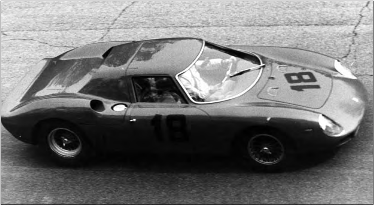
Ferrari 250 LM, telaio 6673, di Carlo Facetti-Nino Vaccarella, ritirati nella 1000 Km di Monza 1966. Il tettuccio forma un tutto continuo con il roll-bar sagomato sopra il cofano motore. I primi esemplari di Pininfarina avevano uno svasso centrale nel tettuccio per incanalare l'aria: non aveva alcuna efficacia e venne eliminato.
