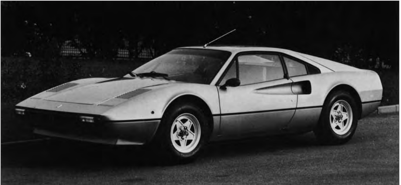
Ferrari 308 GTB Berlinetta 1975. L'omaggio alle linee squadrate di moda negli anni Settanta si armonizza con il disegno della presa d'aria davanti alle ruote posteriori, diventato un classico stilema delle Ferrari Pininfarina a motore centrale. La vettura ha avuto numerosi varianti di meccanica e materiali della carrozzeria, compresa la vetroresina.
