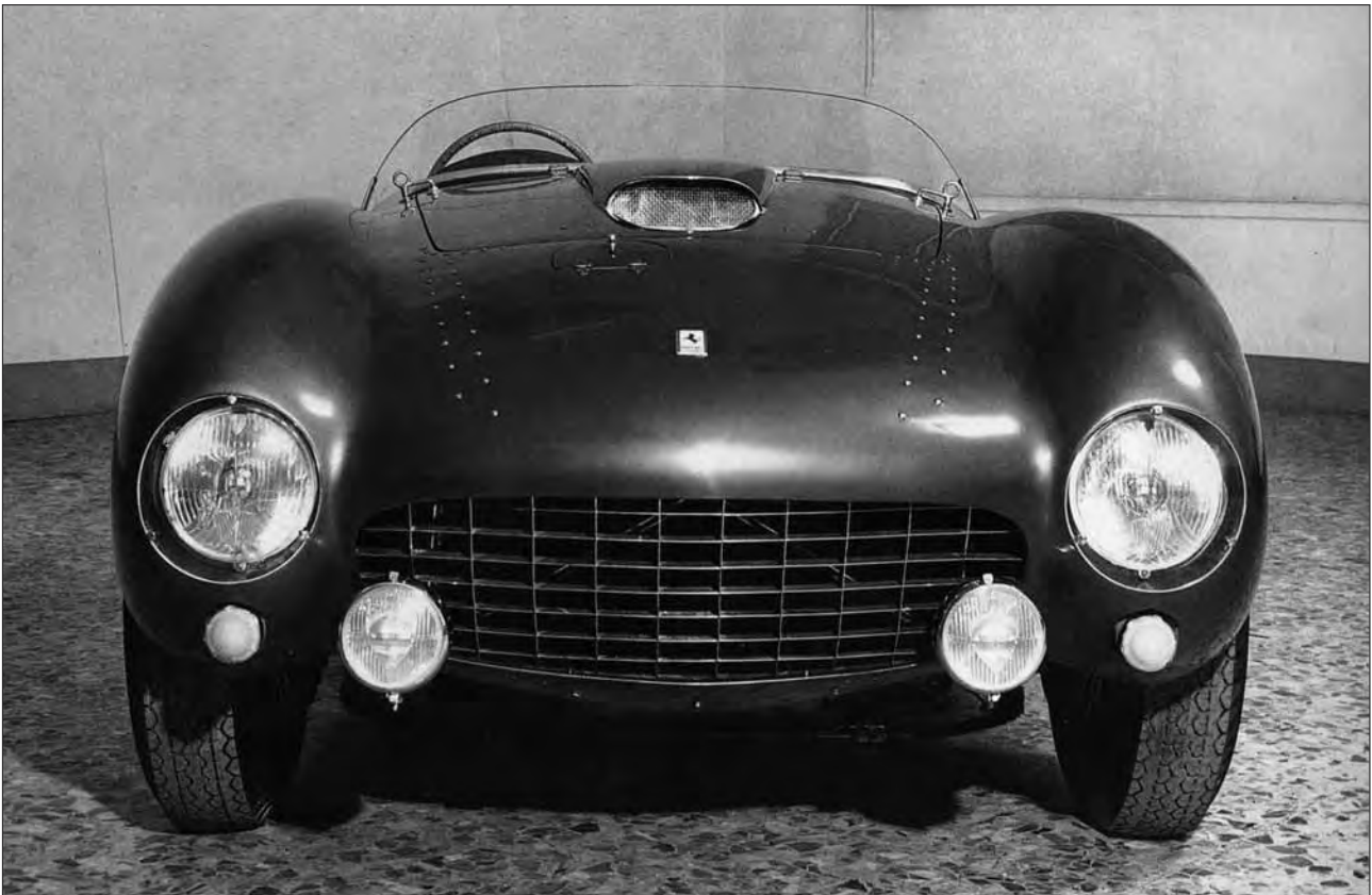
Si osservi il sapiente intervento di Pinin Farina per mascherare le imponenti dimensioni della calandra delle 375 MM. La vettura qui rappresentata, la 0450 AM, è un allestimento tardivo, di taglio stradale, del luglio 1954 per l'imperatore dell'Indocina Bao Dai.
