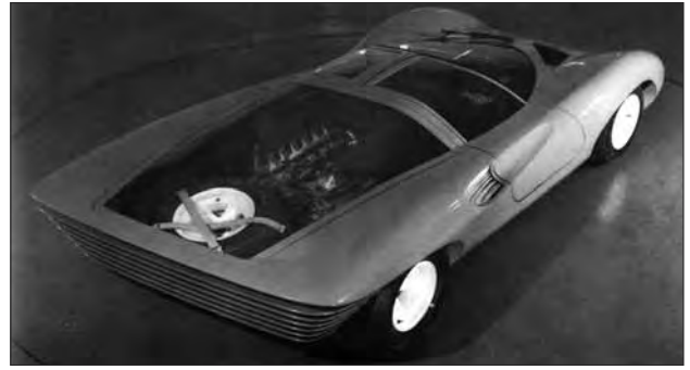
Ferrari 250 P5 Berlinetta Speciale 1968, motore V12 tre litri. Pensata quale successore della 330 P4 resa obsoleta dal cambio dei regolamenti, rimase un esperimento di forma. Rifiutata dalla Ferrari, venne proposta all'Alfa Romeo, che la accettò e si limitò a esporla nel Museo di Arese.
