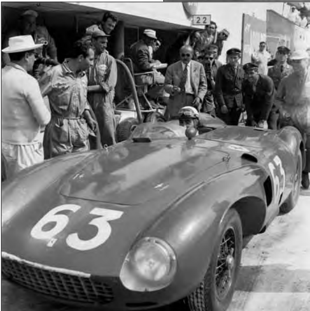
Un'altra immagine della 0642 MDTR con Eugenio Castellotti circondato dai meccanici Ferrari durante le prove, sotto l'occhio vigile di Mino Amorotti. Si notino la posizione dell'apertura di sfogo sulla fiancata e l'andamento del passaruota anteriore.
