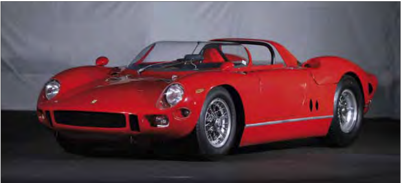
La Ferrari 330 P telaio 0818, 1964, attualmente alla Collezione Maranello Rosso a Falciano di San Marino. L'ottimizzazione del roll-bar carenato consentì di ridurre le dimensioni dello spoiler posteriore e, di conseguenza, ridurre la resistenza. Il roll-bar tubolare che si vede all'interno di quello profilato è un'aggiunta moderna per ottemperare alle regole di sicurezza.
