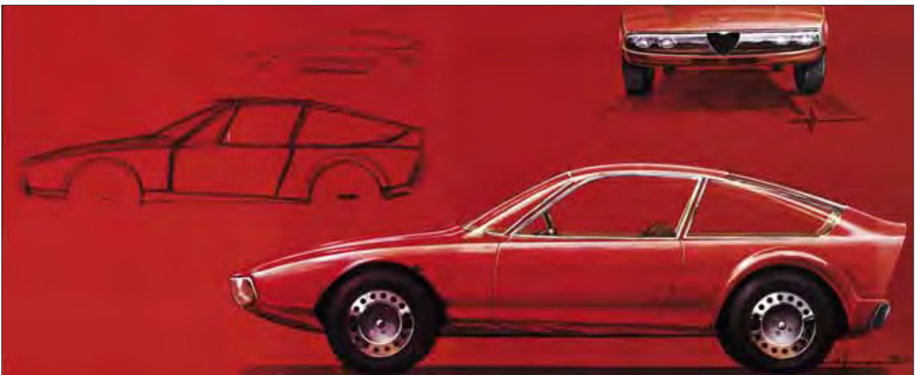
Figurino e schizzi preparatori di Ercole Spada per una versione accorciata della Junior 1300 richiesta dall'Alfa Romeo alla Zagato. La coda è nettamente tronca. L'Alfa Romeo sospese la produzione di questa vettura perché ritenuta, allora, troppo moderna, in particolare nel frontale. Questa è stata l'ultima vettura disegnata da Ercole Spada per la Zagato.
