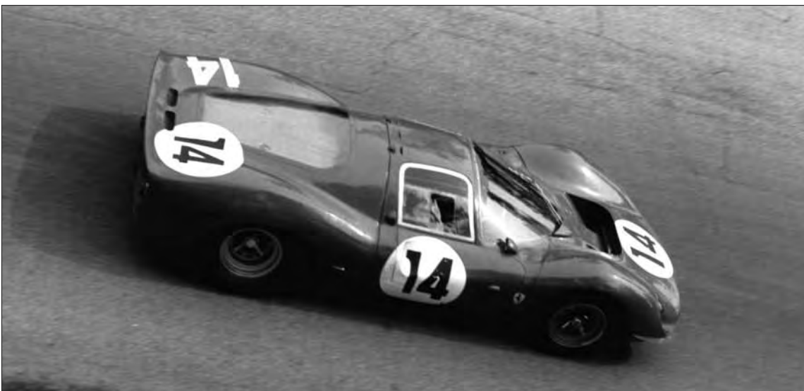
Nella P3 il roll-bar venne integrato nella struttura in modo da svolgere anche una funzione anti-torsionale. Dalle prove in galleria del vento venne deciso di eliminare le prese d'aria del motore. Le due piccole aperture alla base dello spoiler portavano aria fresca ai freni oltre che al motore.
