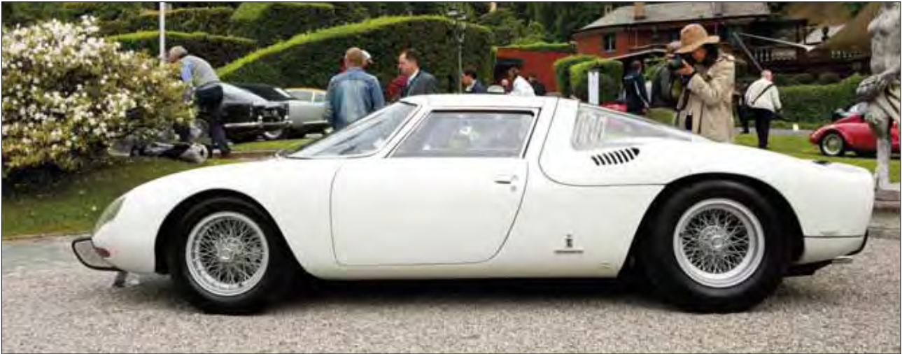
Ferrari 250 LM Berlinetta Speciale 1965, commissionata da un ricco cliente americano e presentata al Salone di Ginevra 1955. Rispetto alla carrozzeria da competizione, caratterizzata dalla troncatura posteriore dell'abitacolo, la linea è continua, il cofano anteriore è più deportante e le due aperture sopra i parafranghi posteriori sono state integrate nella forma. La vettura è stata ripresentata al Concorso di Villa d'Este 2013.
