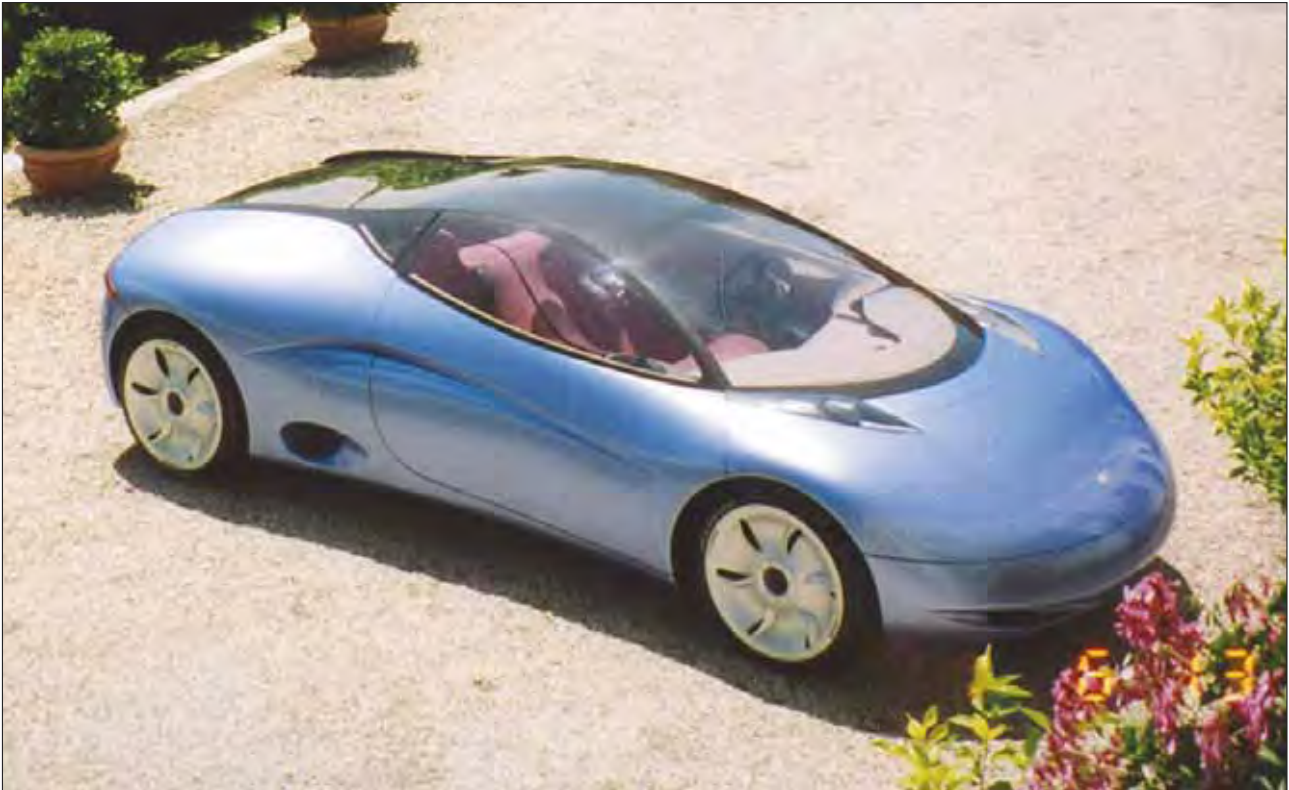
Fioravanti Sensiva, concept di vettura sportiva ibrida presentata al Salone di Torino 1994. Dotata di una piccola turbina a gas e motori elettrici di trazione, prende il nome dagli speciali pneumatici brevettati, che integrano sensori in grado di percepire le condizioni di aderenza e assicurare la guida in massima sicurezza. Il climatizzatore utilizza celle a effetto Peltier, estremamente compatte. La carrozzeria è in compositi a base di fibra di carbonio. Il pilota può richiamare indicatori e dati con un comando vocale.
