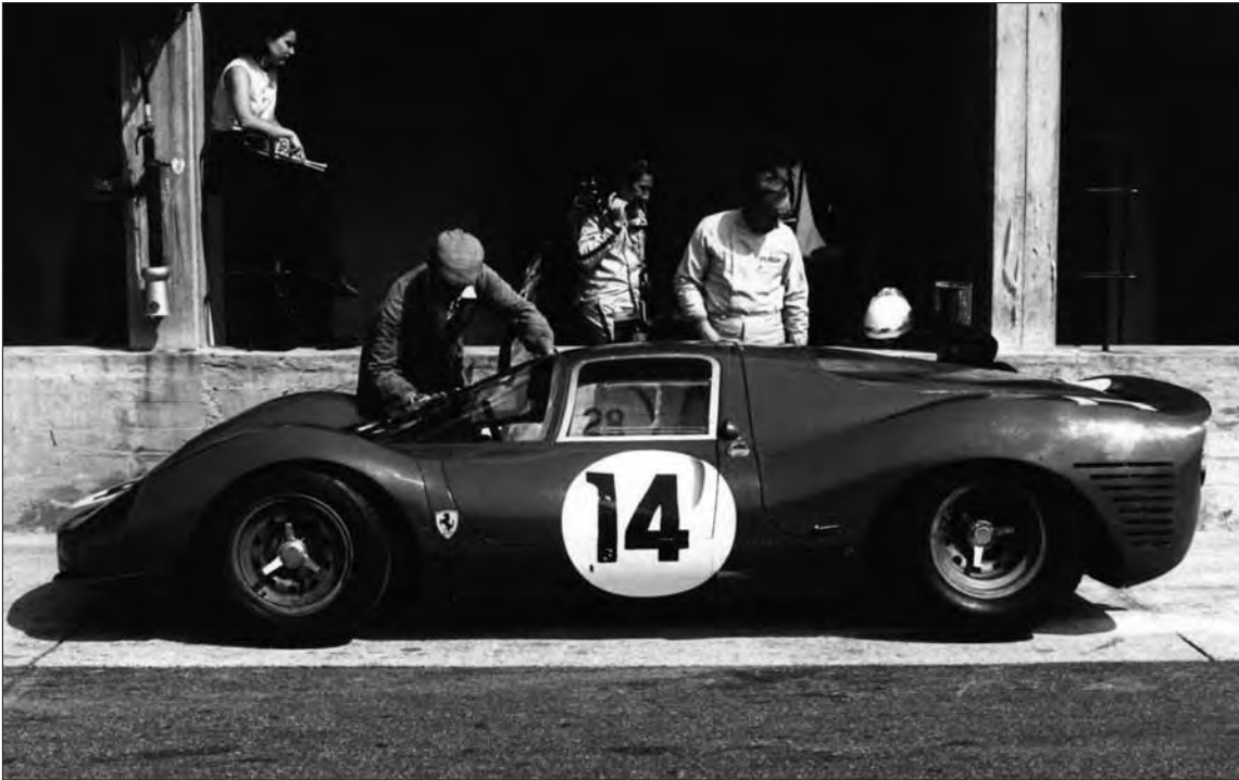
Realizzata dalla Carrozzeria Sports Car a Modena, la 330 P3, 1966, segnò un notevole progresso nell'evoluzione aerodinamica dei prototipi Ferrari. La linea era molto più filante rispetto alla P2 dell'anno prima. L'altezza dei passaggi ruota derivava dall'esperienza accumulata con i salti al Nürburgring.
