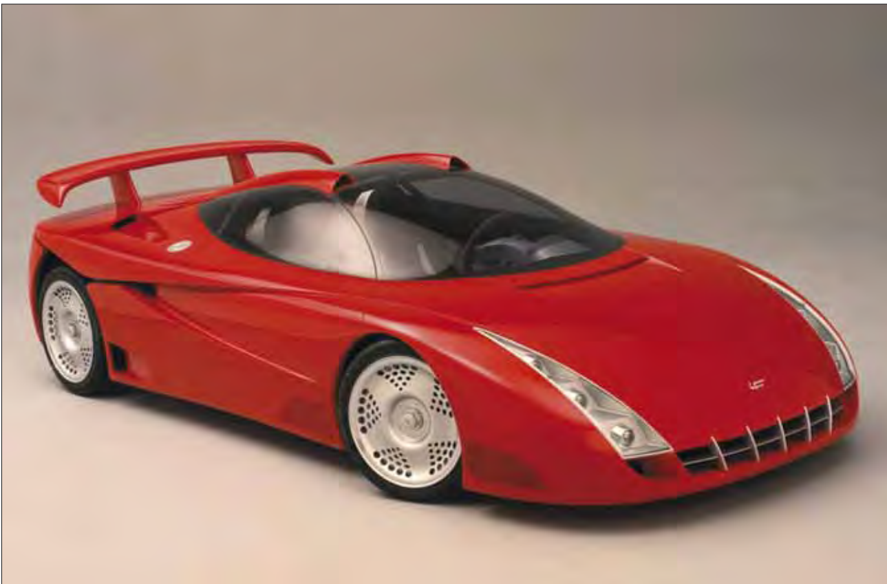
Fioravanti F100, omaggio ai 100 anni dalla nascita di Enzo Ferrari (1898). Era previsto un motore V10 con cambio da competizione dietro il volante. Le prese d'aria per il motore centrale hanno trovato posto sul tettuccio e hanno anche una funzione di irrobustimento. Caratteristica della linea è l'"Onda Ferrari" che segna la fiancata. Le ruote in acciaio sono state appositamente realizzate dalla Fergat. La fanaleria anteriore e posteriore è al neon.
