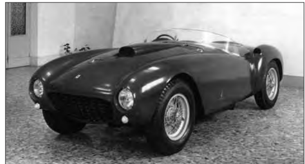
La 375 MM 0366 AM rappresenta un classico esempio di spider sportivo carrozzato da Pinin Farina nel novembre-dicembre 1953 sulla potente meccanica del V12 Lampredi da 4,5 litri.
