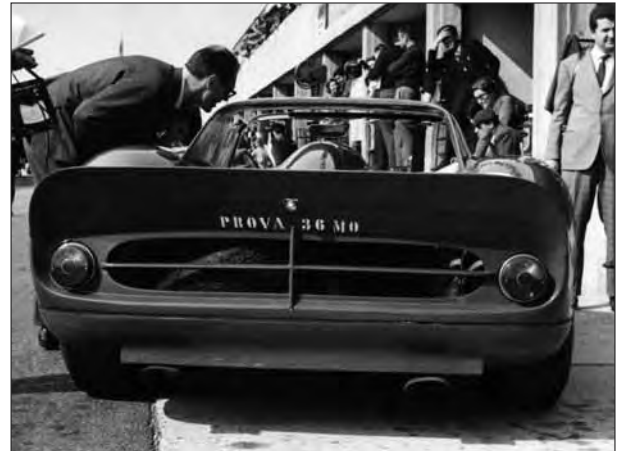
Vista della coda Kamm con il grande spoiler della Ferrari 330 P2, 1965. La cura nell'estetica della carrozzeria è evidente nei due profili ortogonali che attraversano lo sfogo d'aria del compartimento motore, dal bellissimo disegno ovale.
