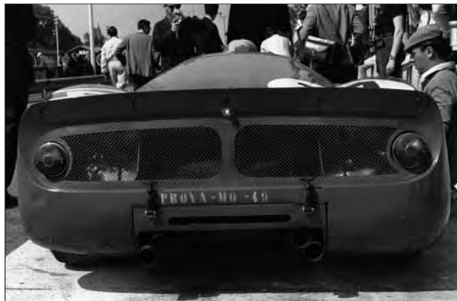
Realizzata dalla Carrozzeria Sports Car a Modena, la 330 P3, 1966, segnò un notevole progresso nell'evoluzione aerodinamica dei prototipi Ferrari. La linea era molto più filante rispetto alla P2 dell'anno prima. L'altezza dei passaggi ruota derivava dall'esperienza accumulata con i salti al Nürburgring.
