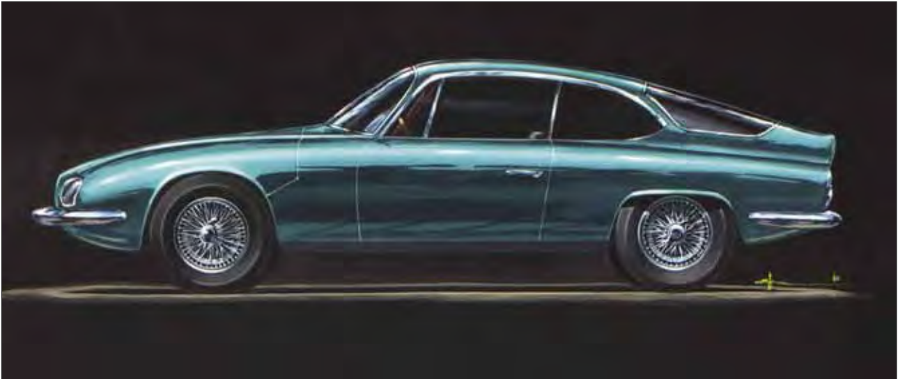
Il figurino dell'Alfa Romeo 2600 Zagato nella prima proposta di Ercole Spada. Le dimensioni del pianale hanno costretto ad allungare la linea del padiglione. L'Alfa Romeo volle poi cambiare questo tipo di coda.
